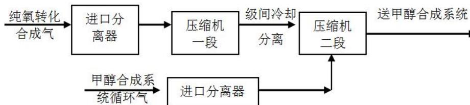
图 3.1.9 甲醇合成气压缩机工艺流程简图
